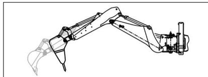
Installation du marteau hydraulique + Balancier télescopique
