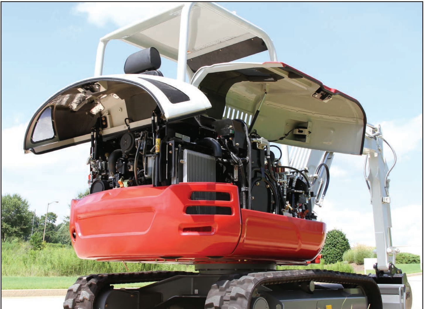
Larges capots latéraux à fermeture à clef
