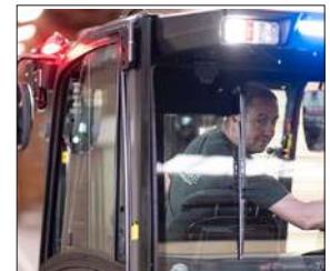
Éclairage de sécurité figurant des points bleus et des lignes rouges
