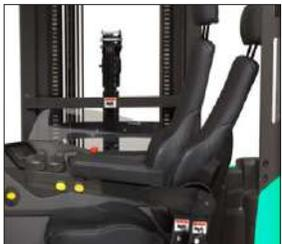
Siège réglable avec dossier haut et fonction d'inclinaison
