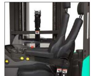
Siège réglable avec dossier haut et fonction d'inclinaison
