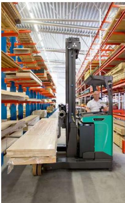
**Capables de lever jusqu'à 9,7 mètres, les chariots de la Série RBM20-25N3 peuvent transporter de longues charges dans le sens transversal et travailler dans des allées étroites, économisant ainsi l'espace de stockage**
