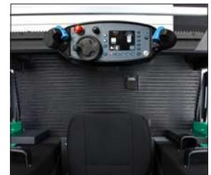
Panneau de commande avec commande par boule
