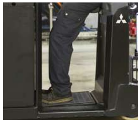
Plateforme opérateur suspendue.
