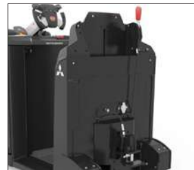
Attelage automatique avec poignée de déverrouillage ergonomique.
