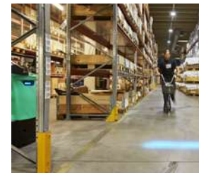
Éclairage de sécurité Blue-spot dans le sens de conduite.
