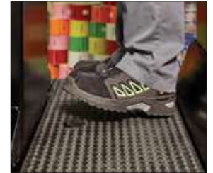
Pédale d'abaissement de la plate-forme opérateur.
