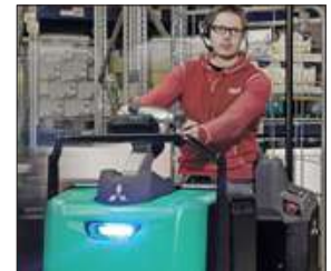
Éclairage de sécurité "Blue Point" dans le sens de conduite.
