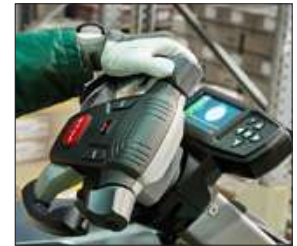
Volant de direction multifonctionnel avec affichage couleur.
